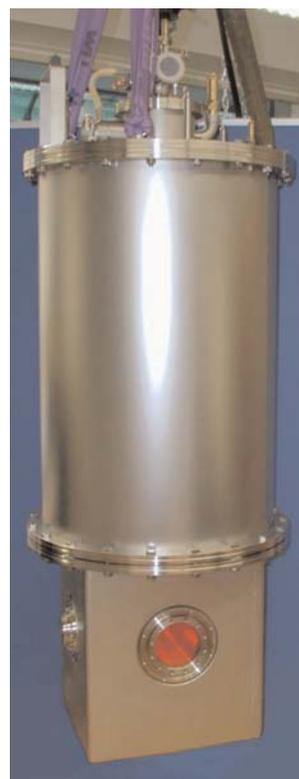
Abb. 1: Optischer Magnetkryostat.
